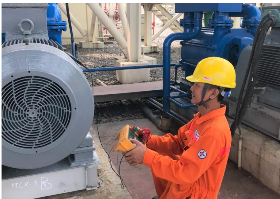
Kỹ sư của Công ty đo điện trở đất trong mùa khô
